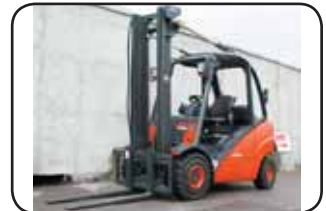
Дизельный погрузчик Linde H30D, H2X393U01746, 2007 г., г/п 3.000 кг, в/п 3.950 мм, сайдшифтер, наработка 6.502 м/ч. Подготовлен. Linde Material Handling Rus, +7 (495) 258-40-45. Цена: 990.000 руб., вкл. НДС 18%
